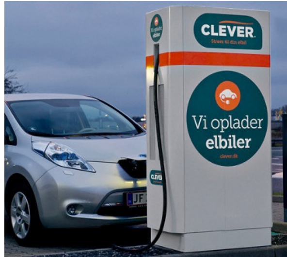
Stazione di ricarica pubblica modo 4 da 50 kW (Clever)
