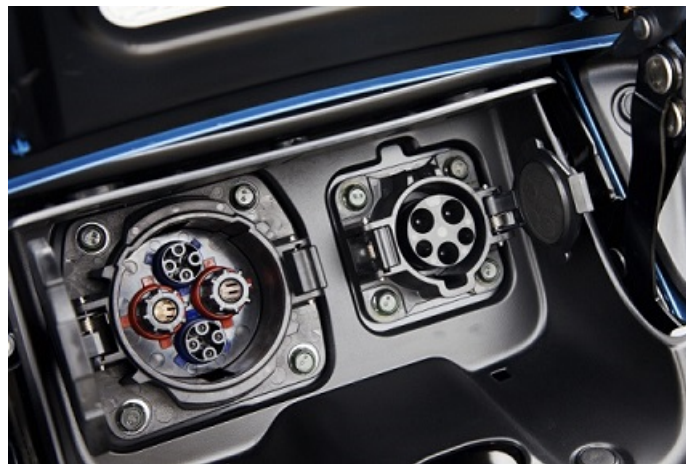
Connettore CHAdEMO e tipo 1 su un veicolo (Nissan)
