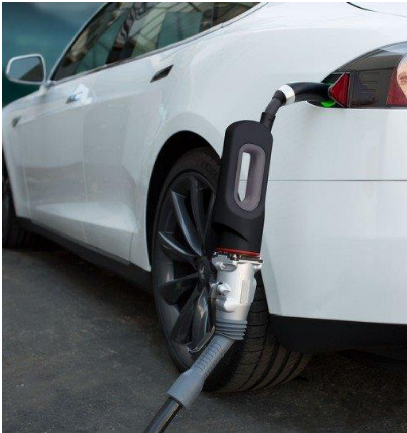
Autovettura Tesla in carica da un sistema CHAdeMO tramite adattatore
