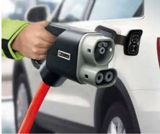
Connettore Combo2 (Phoenix Contact)
