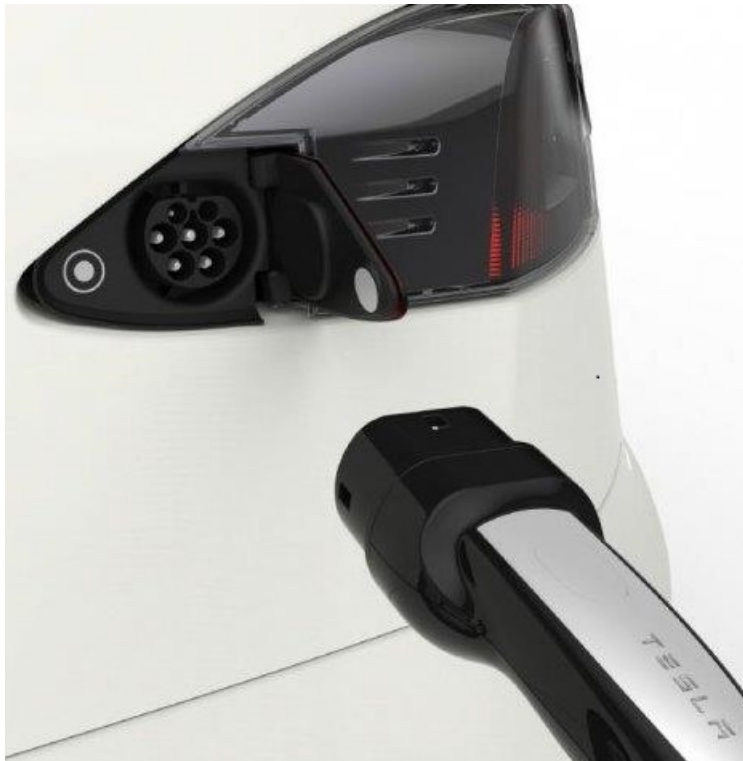
Connettore Tesla S ac/dc versione europea
