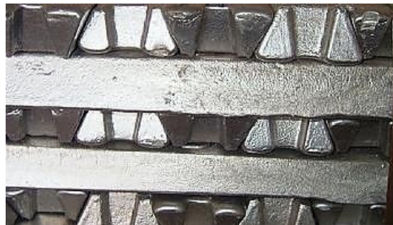
Lingotti di alluminio ottenuti in fonderia
