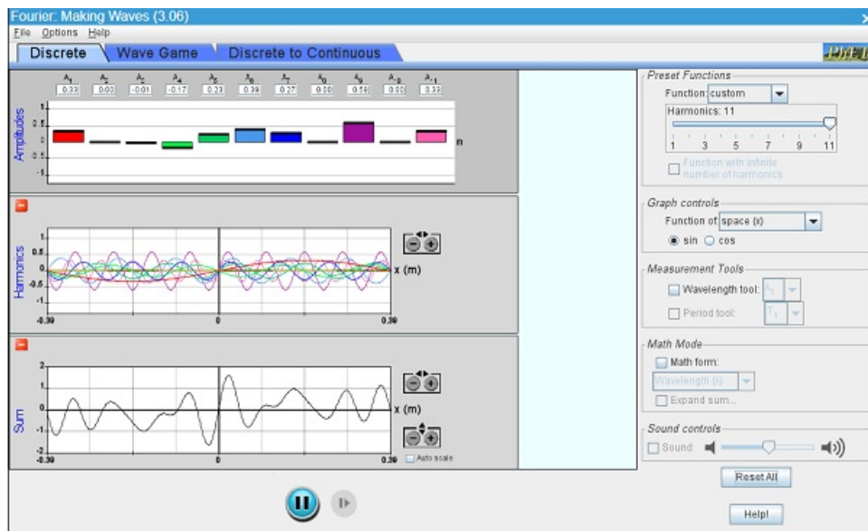
Fourier visualizzato. Costruzione di un segnale mediante somma di sinusoidi
