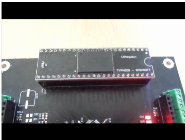
PIATTAFORMA HARDWARE E.R.D. - MEMORIA FLASH REMOVIBILE. © - 5
