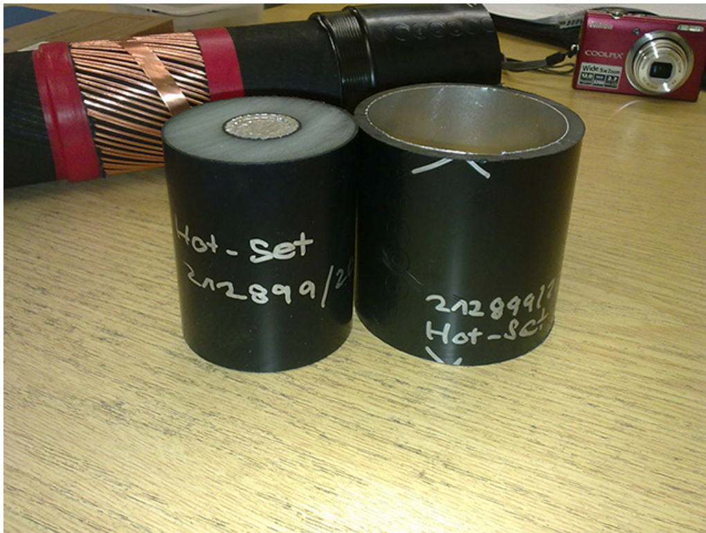
Altra foto sulla composizione del cavo e relativi provini da sottoporre ai test.
