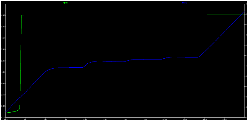
Figura 14 - Tensione di alimentazione e corrente del TL431
