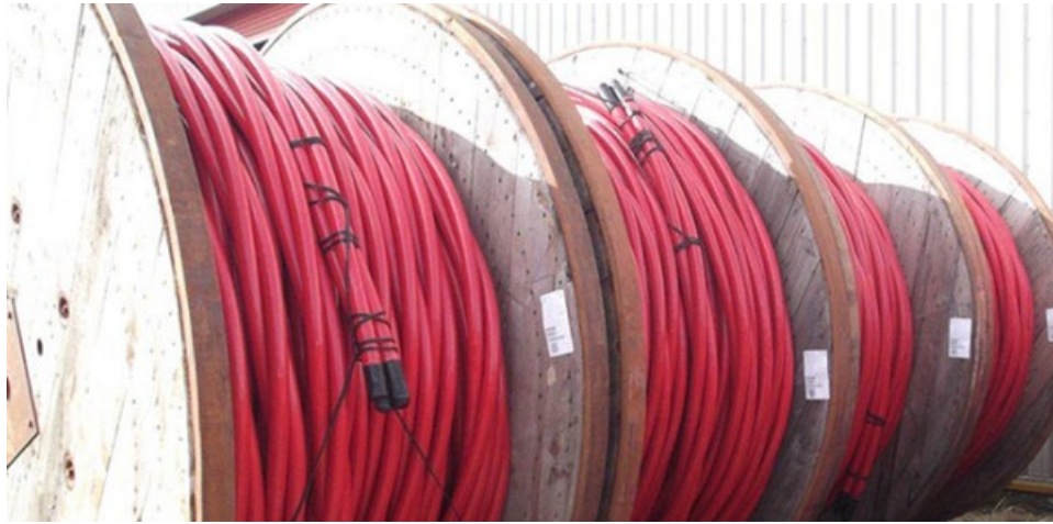
Cavi MT ad elica visibile per posa interrata
