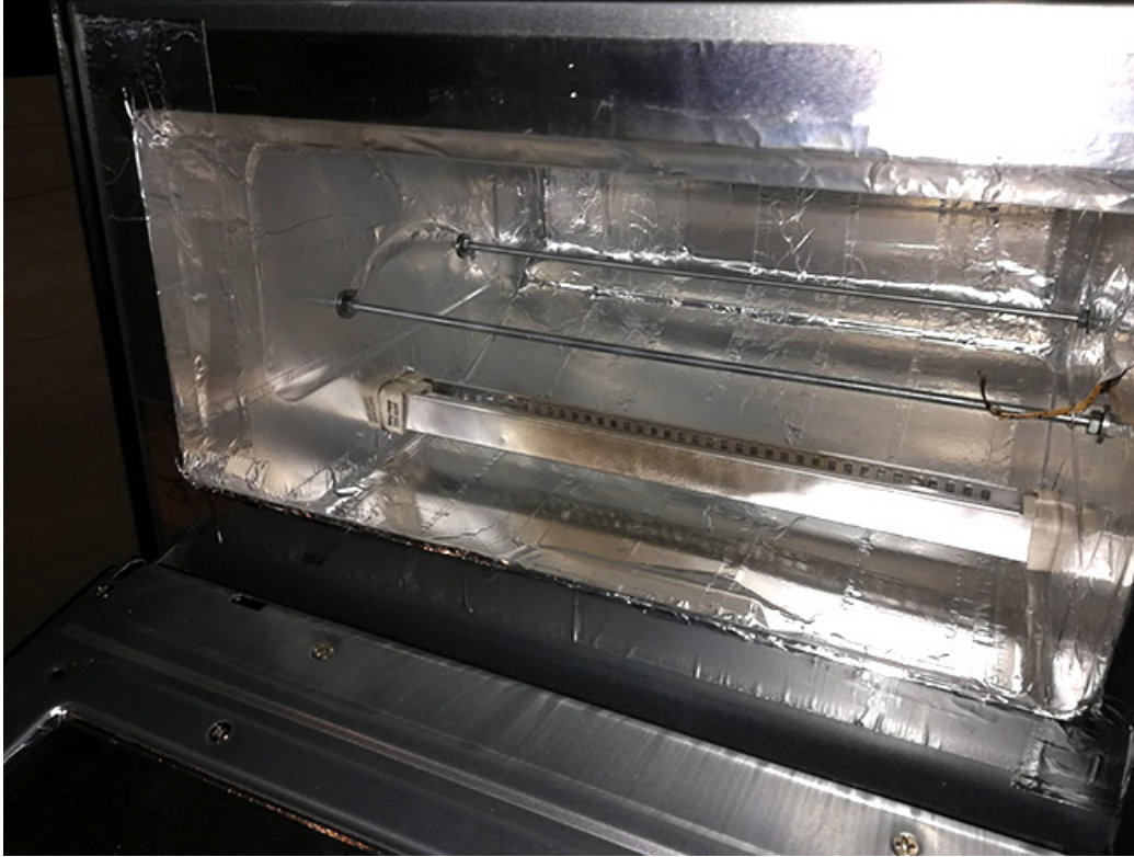
Camera isolata (termocoppia visibile a destra)
