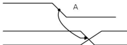
In questo ulteriore esempio il fronte di salita del segnale "A" provoca una variazione di livello da basso ad alto del segnale "B" che a sua volta provoca una variazione di livello su un bus.
