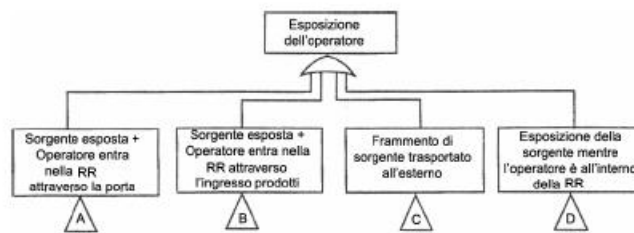
Fig. 9. Livello 0 dell'albero di guasto.
