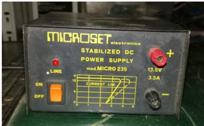
Fig. 1 - Microset Micro 235, tensione fissa 13.5V, 3.5A
