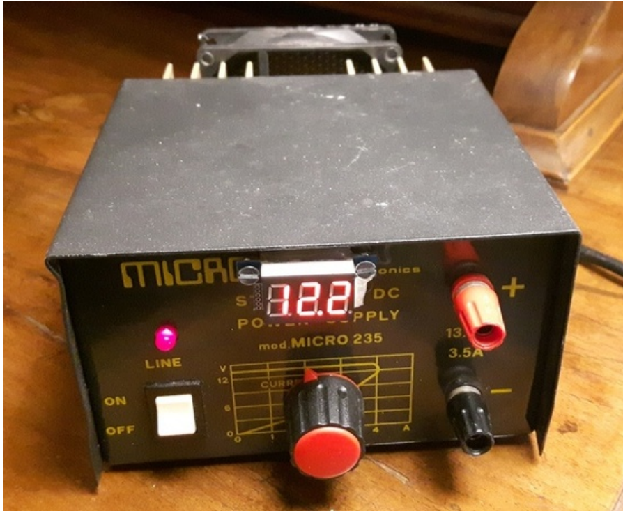
Fig. 5 - alimentatore Microset Micro 235 modificato (fronte)
