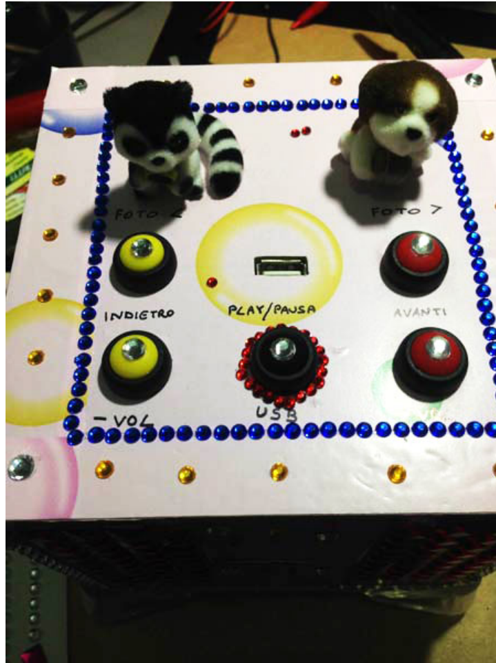
Anteprima del progetto finito - lato superiore: controllli MP3, controllli cornice digitale, USB per chiavetta con MP3 e pupazzetti decorativi.
