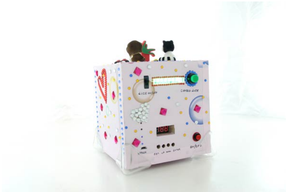
Anteprima del progetto finito - lato retro: lampada RGB, timer, indicatori batteria e interruttore generale
