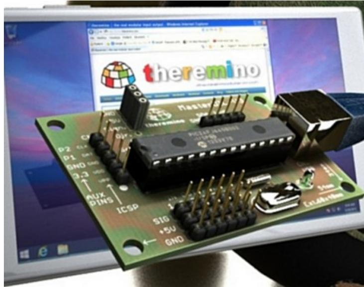
Con il sistema Theremino si possono quindi progettare e costruire apparecchiature elettroniche collegate al computer anche senza scrivere una sola riga di firmware o di software.
