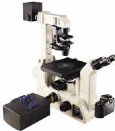
Figura 8 - Sistema di microscopia confocale a fluorescenza costituito da un microscopio TE300 e sistema di scandione PCM2000 (congegnio nero a fianco del microscopio)
