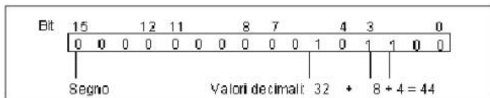
Fig. 7 Esempio di rappresentazione del numero INT +44 in una word in codifica binaria :
